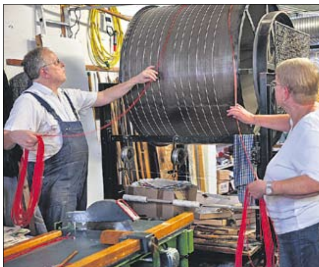
Die fertigen Wachsstränge werden abgenommen.
