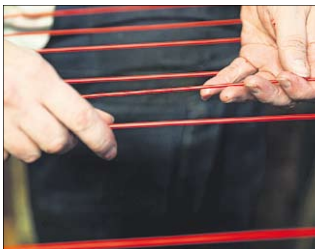
Immer wieder werden die Wachsstränge auf Gleichmäßigkeit kontrolliert.
